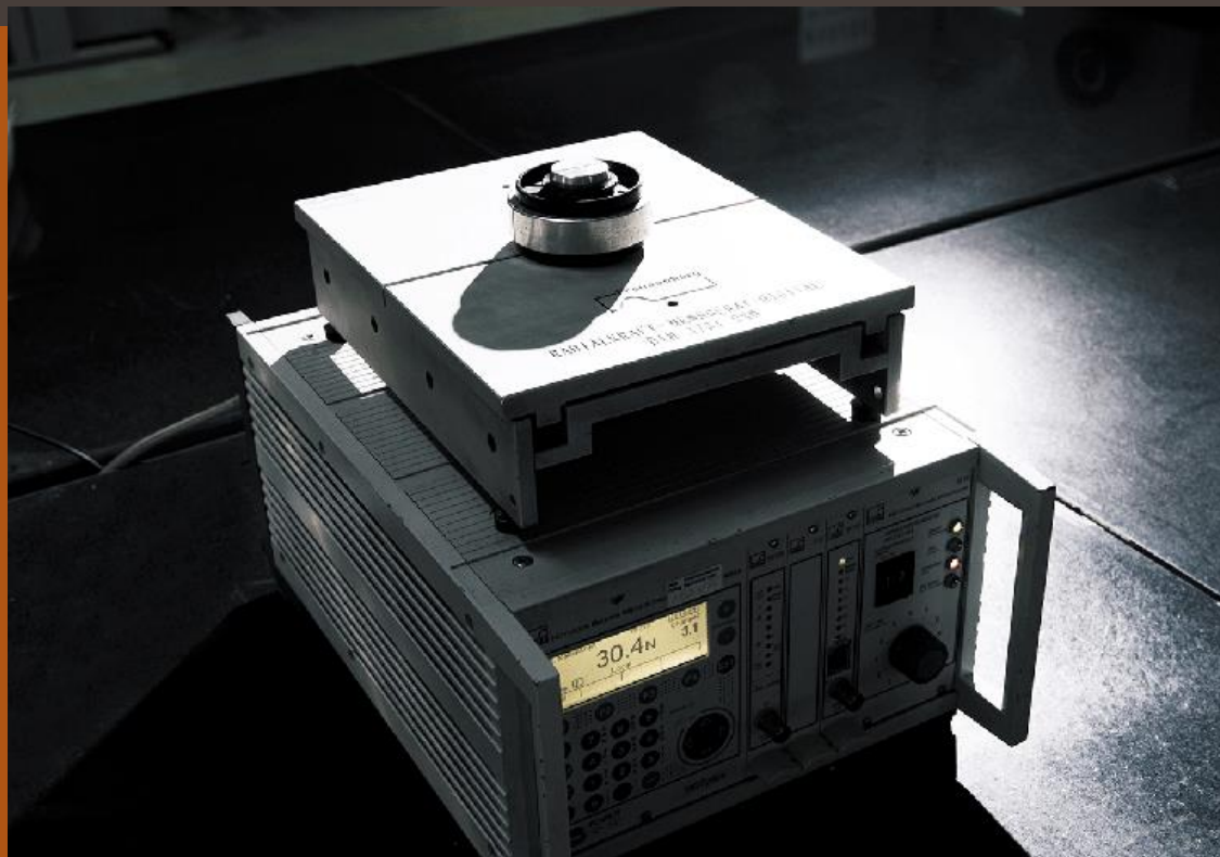
油封緊迫力測試機
