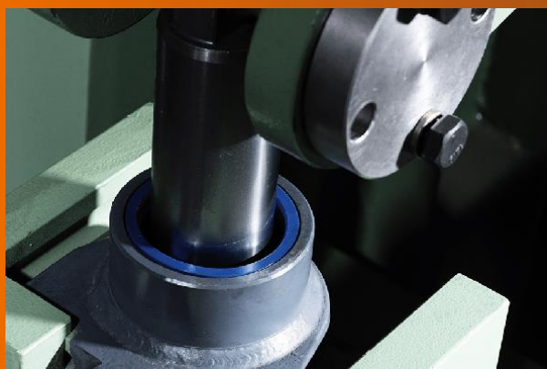
油封壓力測試機
